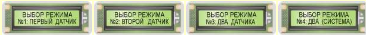
Рис. 9.1. Вид ЖКИ БУК при выборе номера режима применения влагомера (мигающий курсор подсвечивает номер текущего режима применения);
