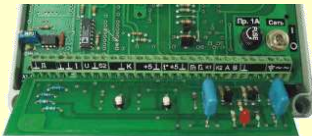
Рис. 4.4. Подключение ТПД к блоку управления и контроля
