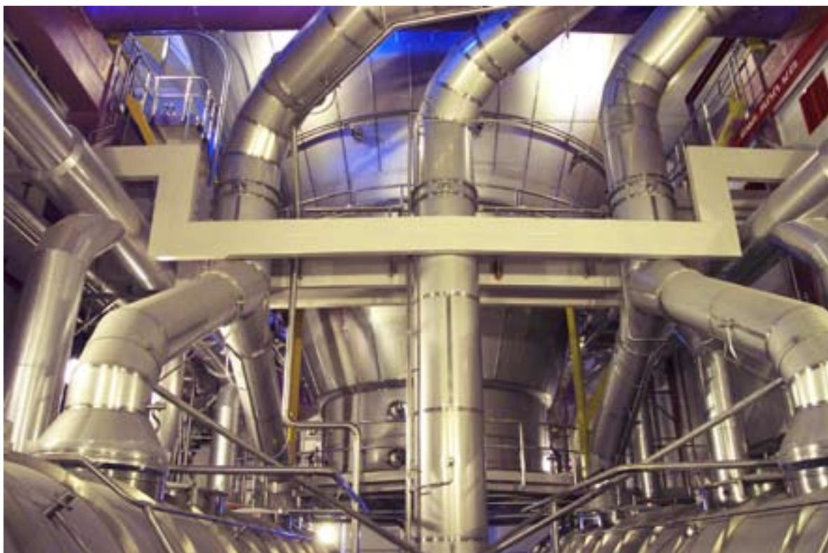
Нижняя часть распылительной сушилки MSD и присоединенный к ней аппарат Vibro-Fluidizer для досушки и охлаждения.
