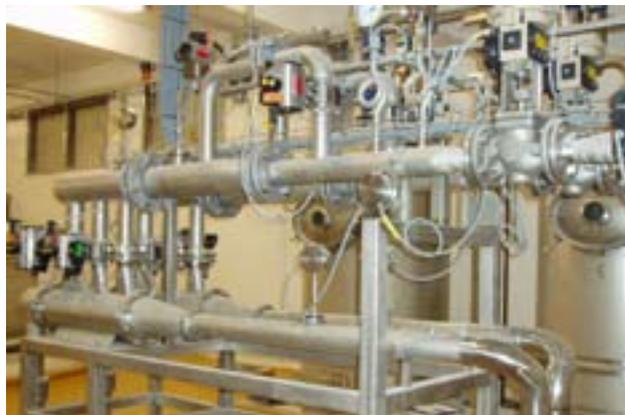
Рис. 26 Система контактной пастеризации с контактным регенеративным подогревателем мгновенного испарения.
