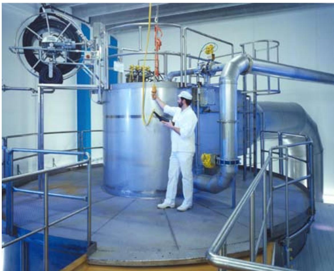
Верхняя часть башенной распылительной сушилки (TFD) – узел форсунок в воздухораспределителе.
