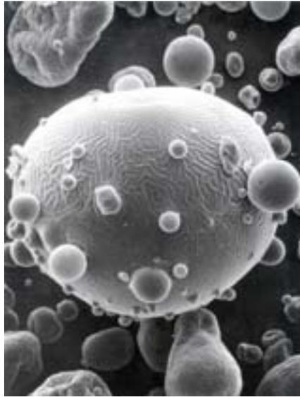
Рис. 73 Типичная частица после одноступенчатой сушки.
