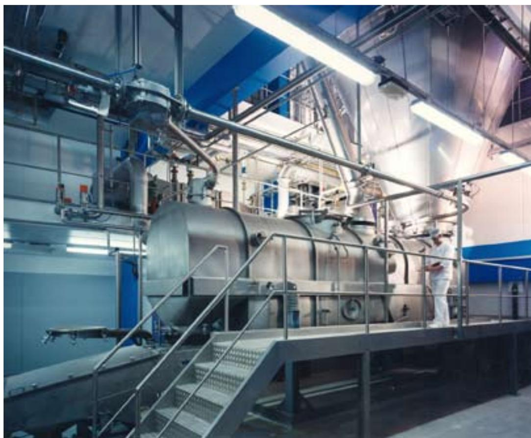
Коническая часть распылительной сушилки присоединенный к ней Vibro-Fluidizer
