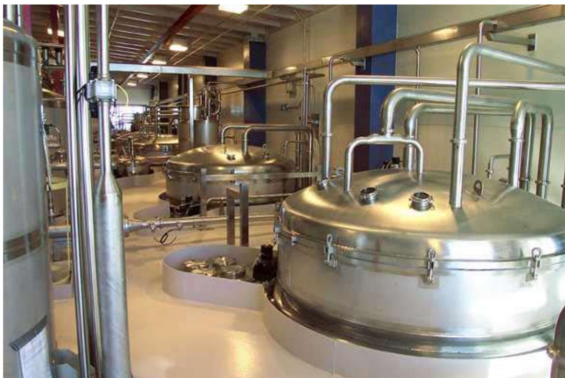
Верхняя часть нагревательной камеры выпарного аппарата (система распределения сыря)
