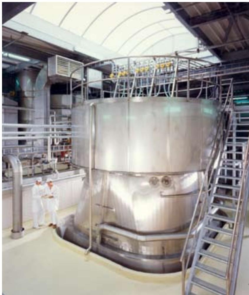
Верхняя часть распылительной сушилки FILTERMAT – узел форсунок и воздухораспределитель.
