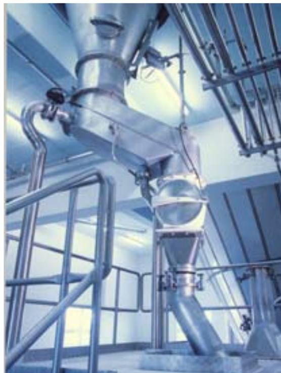
Рис. 61 Пневмоконвейер для предварительного охлаждения порошка.
