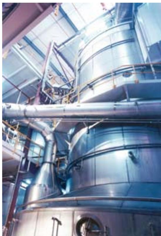
Рис. 140 Башенная сушилка для производства сывороточного белка (TFD).
